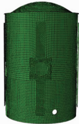
图 3 普通钢筋的有限元模型
